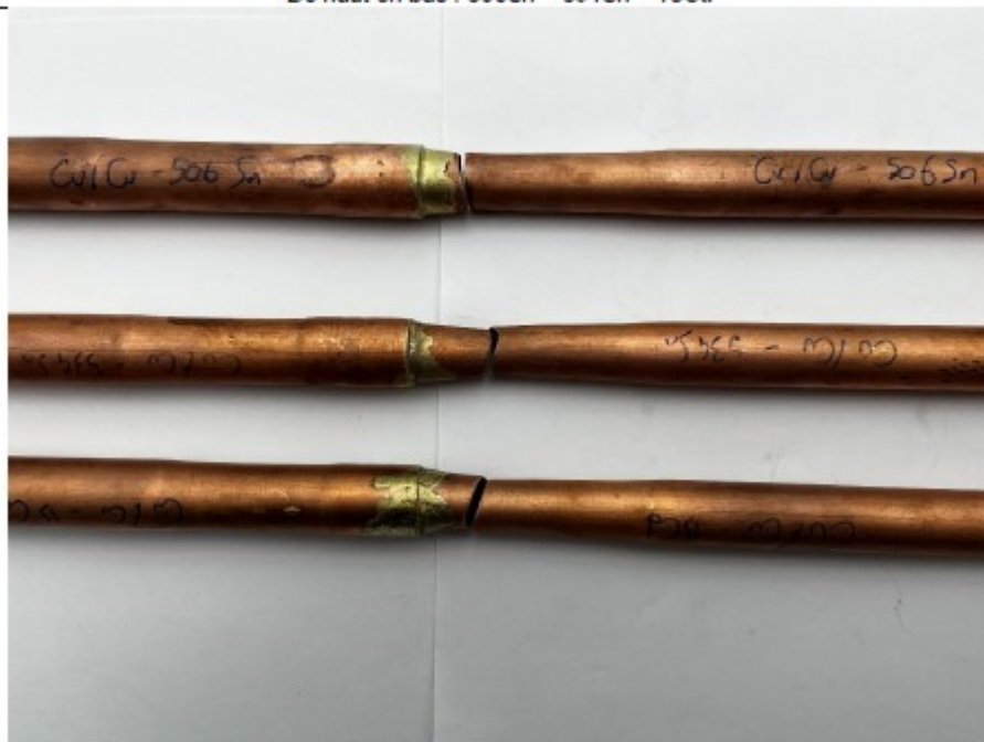
Eprouvettes assemblées après essais de traction : Assemblage Cu/Al De haut en bas : 506Sn – 534Sn – 15Cd
