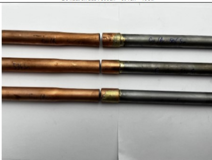
Eprouvettes assemblées après essais de traction : Assemblage Cu/Al De haut en bas : 506Sn – 534Sn – 15Cd
